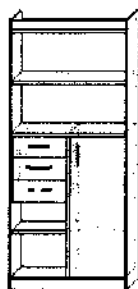
skriňa 3-zás výška: 1800mm šírka: 800mm hĺbka: 290mm
